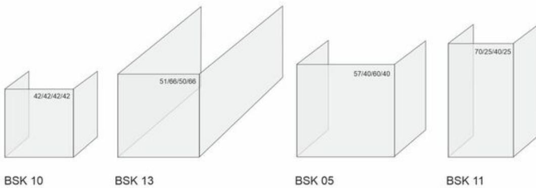
Données format porte hauteur x largeur côté x largeur avant x largeur côté en cm
